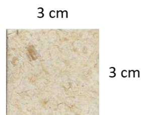
ภาพที่ 13 ชิ้นงานตัวอย่างพอลิเมอร์ธรรมชาติ สำหรับทดสอบความชื้น
