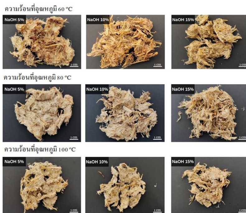
ภาพที่ 15 ลักษณะของเส้นใยฟางข้าวที่เตรียมได้จากการใช้ความร้อนที่แตกต่างกัน
