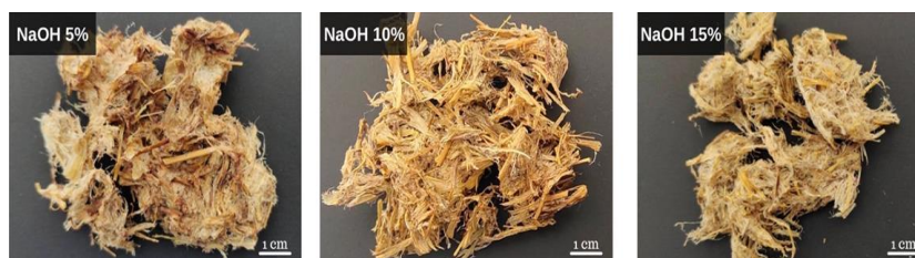
ภาพที่ 14 ลักษณะของเส้นใยฟางข้าวที่ได้จากการใช้สารละลาย NaOH ที่ความเข้มข้นแตกต่างกัน
