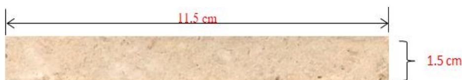
ภาพที่ 12 ชิ้นงานตัวอย่างพอลิเมอร์ธรรมชาติ สำหรับทดสอบแรงดึง
